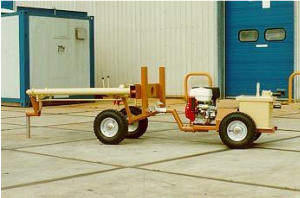
Moduł penetrometru połączony z modułem układu hydraulicznego.
