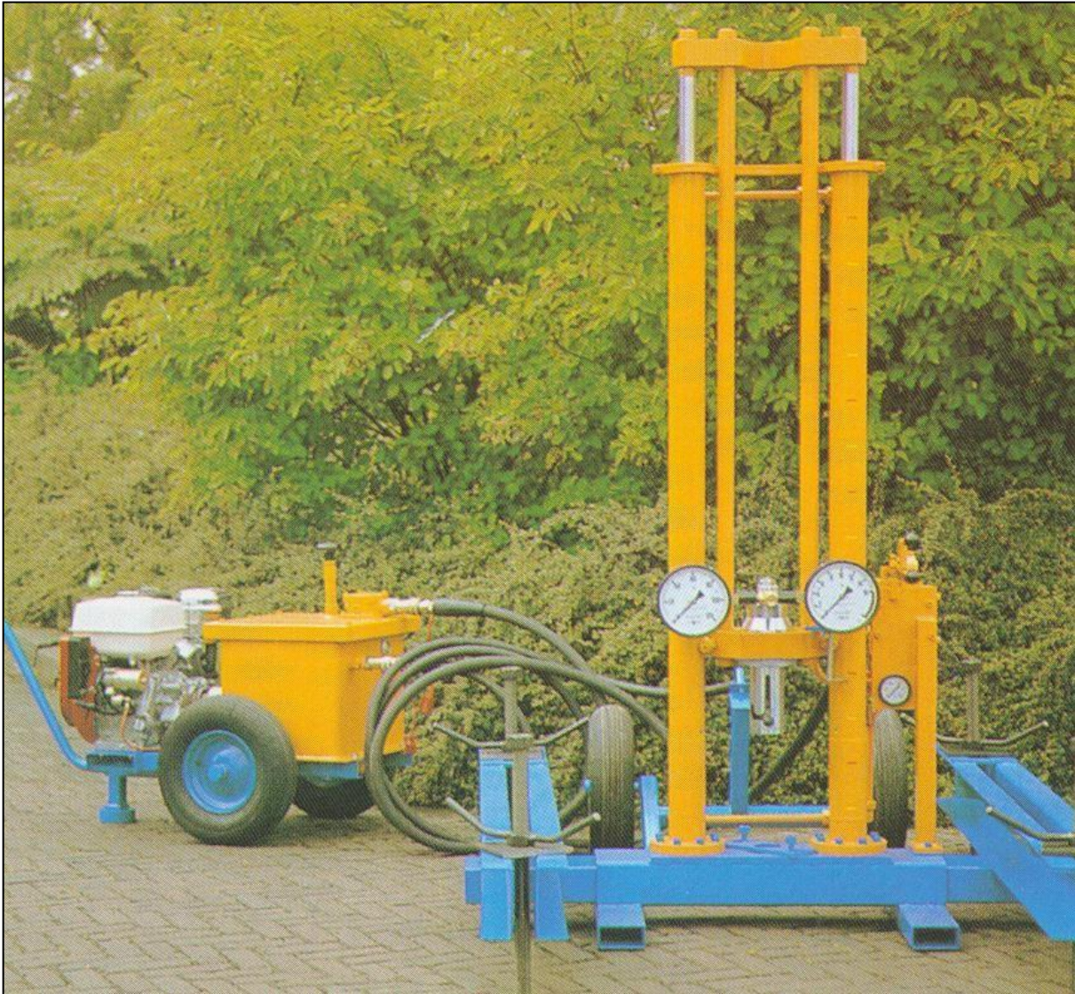
Widok ogólny penetrometru (wersja standardowa z głowicą mechaniczną) w stanie rozłożonym.
