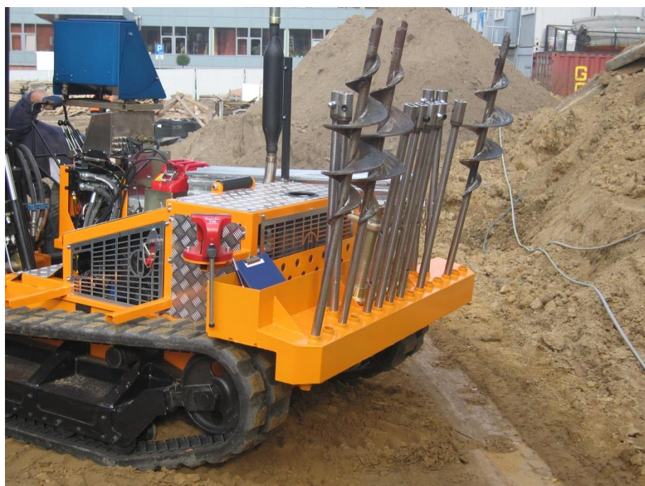
Wiertnica Geotech 220-10 z rozbudowanym panelem tylnym i imadłem.
