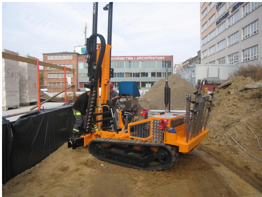
Wiertnica Geotech Georig 220 w wersji z gąsienicami Rubber Track
