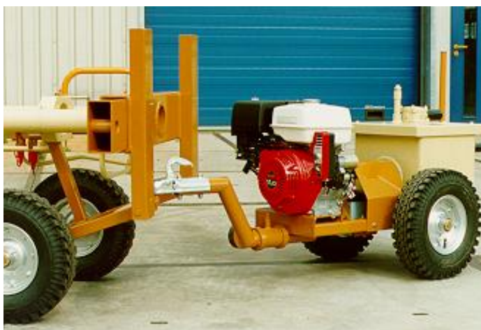
Połączenie głównych modułów sondy do transportu w terenie.
