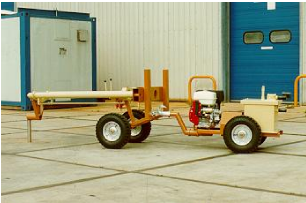
Moduł penetrometru połączony z modułem układu hydraulicznego.
