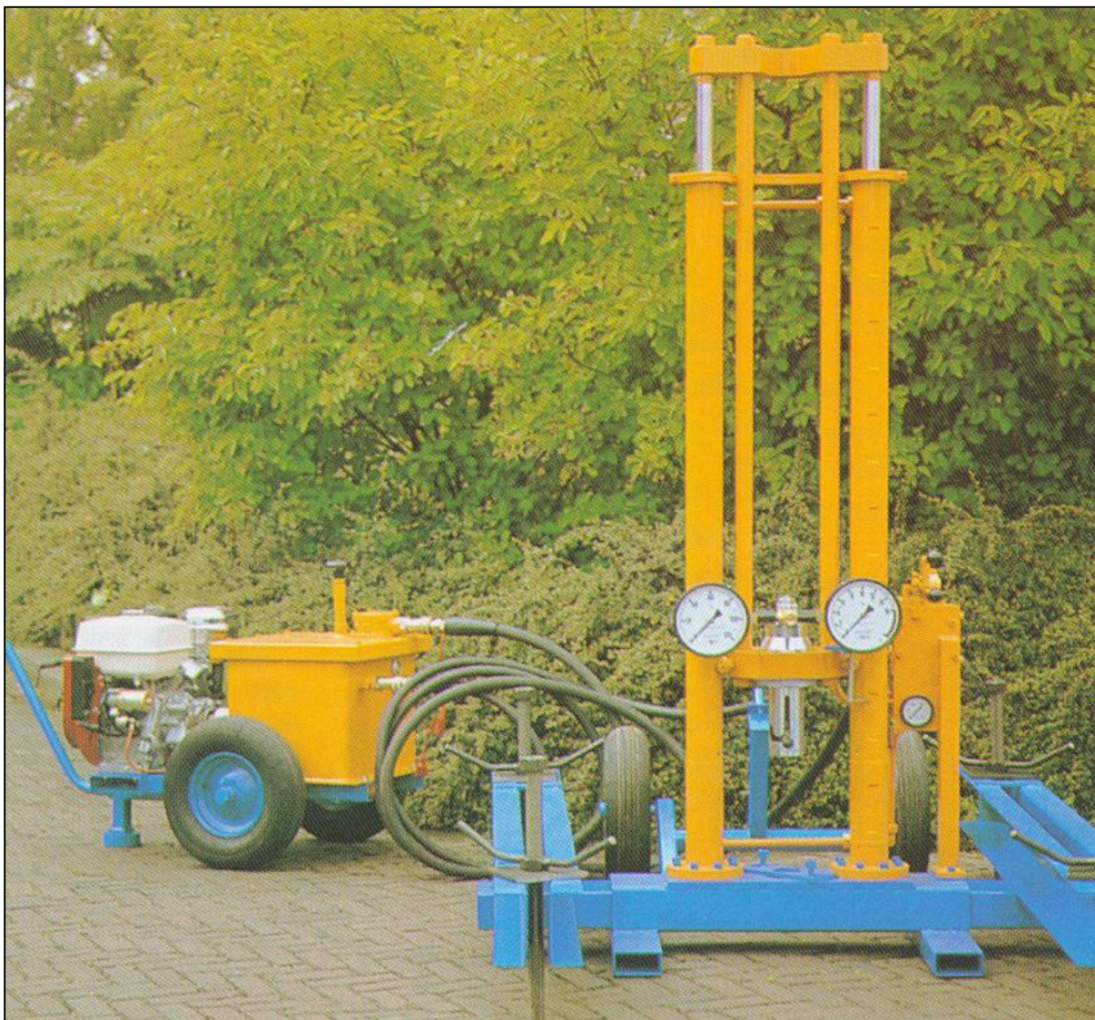
Widok ogólny penetrometru (wersja standardowa z głowicą mechaniczną) w stanie rozłożonym.
