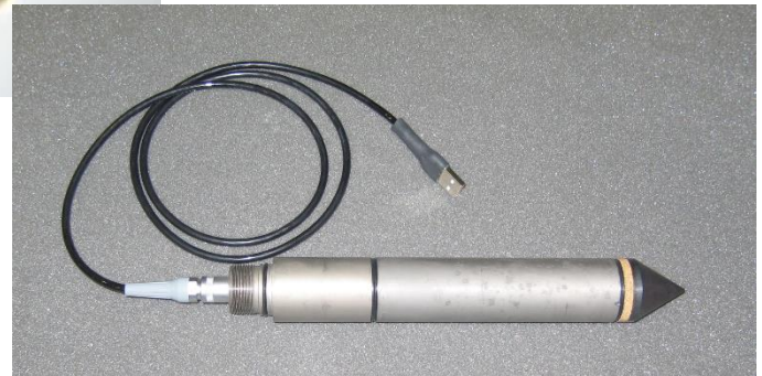
Stożek CPTU NOVA z kablem USB do czytania danych z pamięci
